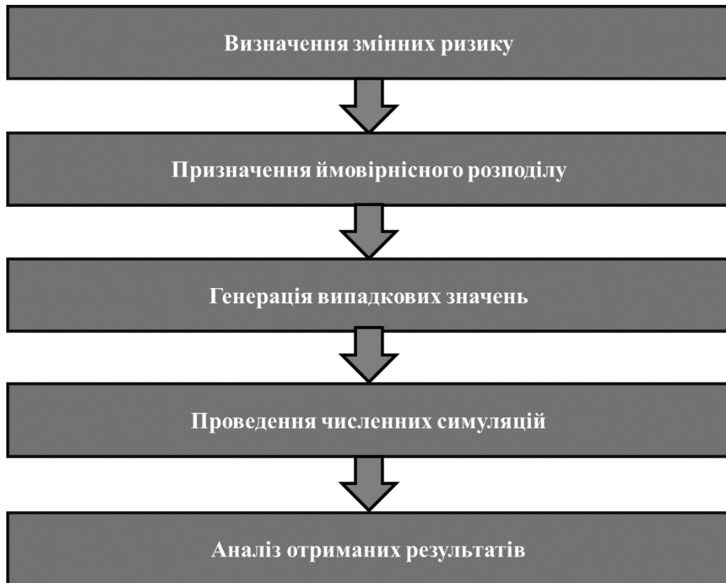
Рис. 2. Процес моделювання методом Монте-Карло
