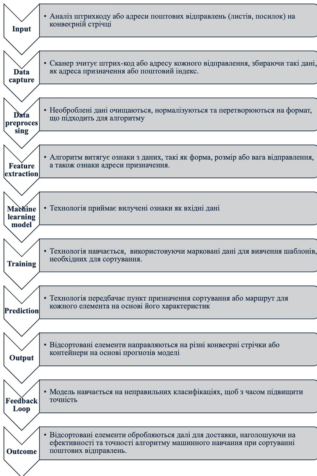
Рис. 1. Схема алгоритму машинного навчання, що обробляє поштові відправлення для сортування Джерело: авторська розробка
